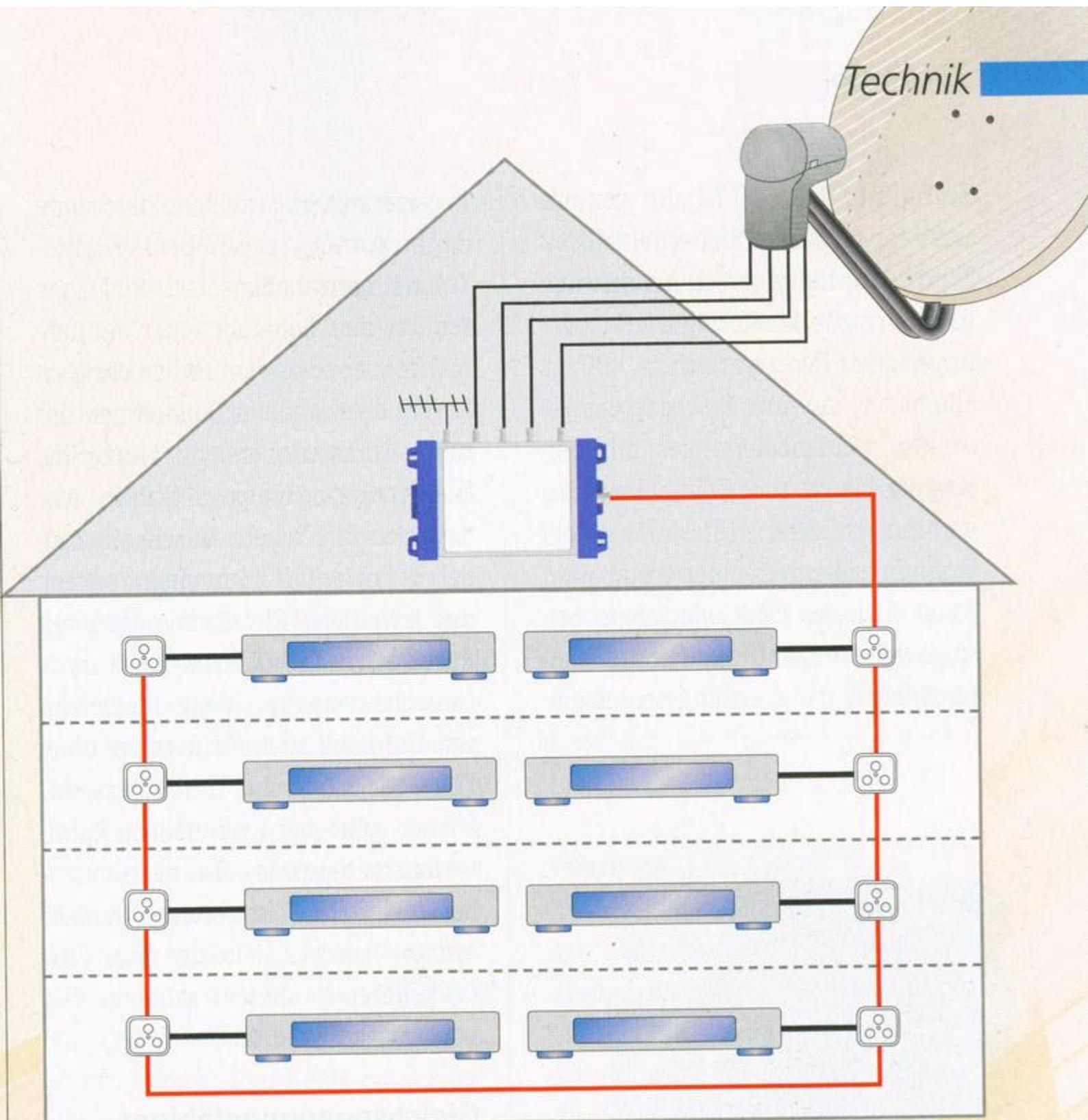
Bis zu acht Empfänger können an einem Kabelstrang gleichzeitig versorgt werden
