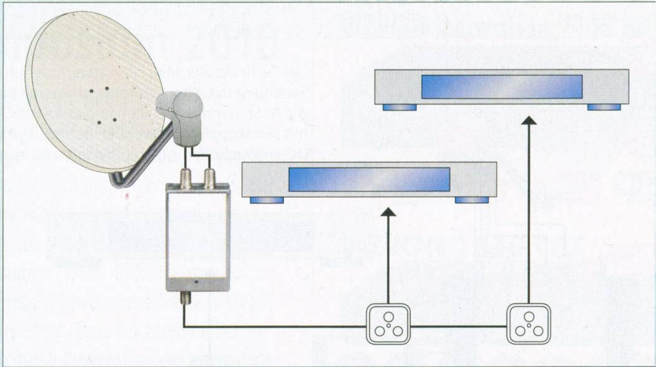
Prinzipdarstellung TechniRouter Mini, falls Twin-Empfang über eine verfügbare Koaxialleitung realisiert werden soll. Der TechniRouter Mini nutzt niedrige Transportfrequenzen, wodurch die Anforderungen an das Koaxialkabel geringer als bei der Stacker/De-Stacker-Lösung sind. In diesem Fall sind die Stromversorgung des TechniRouters und des LNBs, sowie der maximale Eingangspegel des TechniRouter Mini (80 db (uV)) zu beachten
