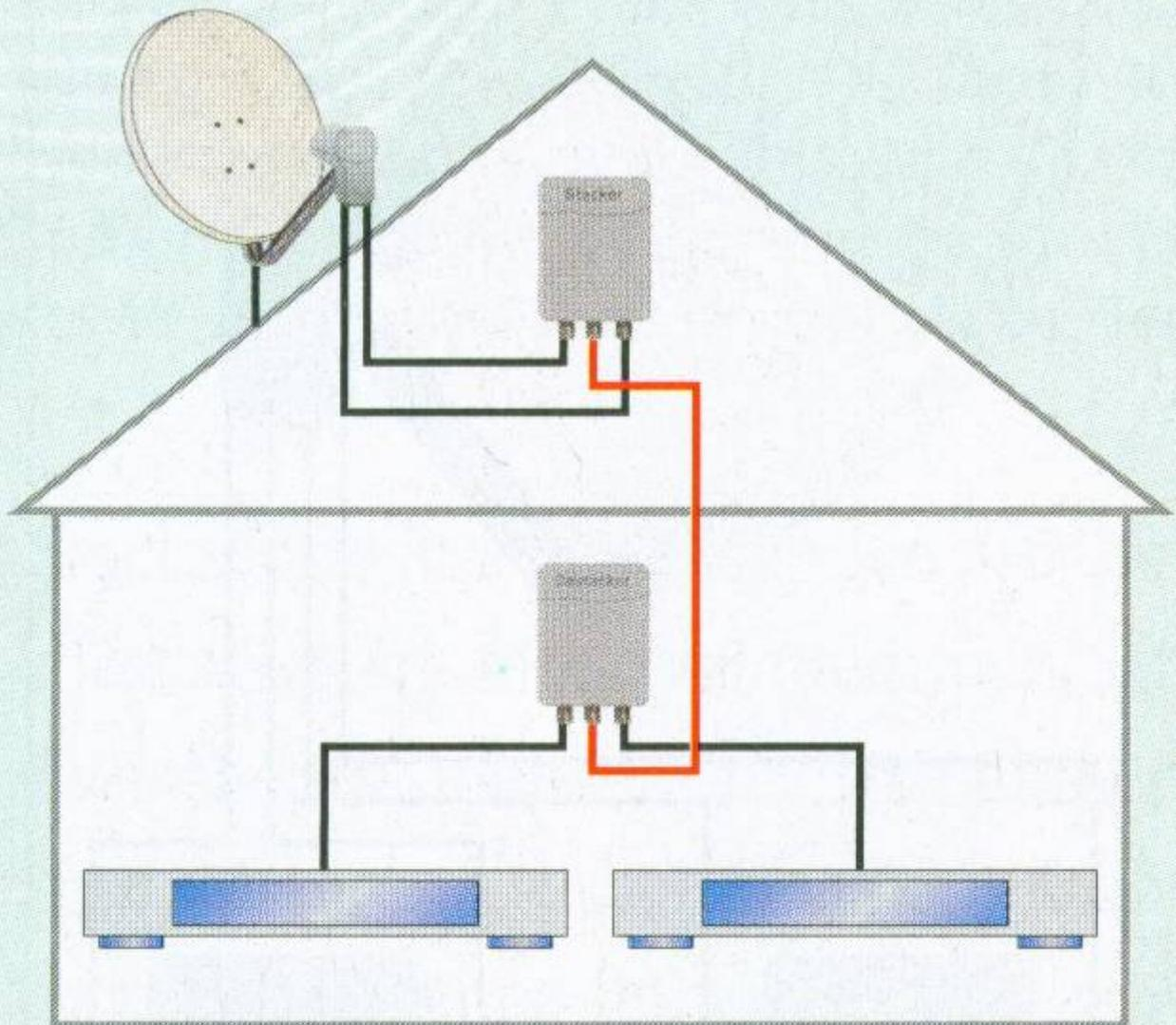
Prinzipdarstellung Stacker/De-Stacker, falls Twin-Empfang über eine verfügbare Koaxialleitung realisiert werden soll. Der Stacker sollte möglichst nahe am Twin- oder Quad-LNB montiert werden
